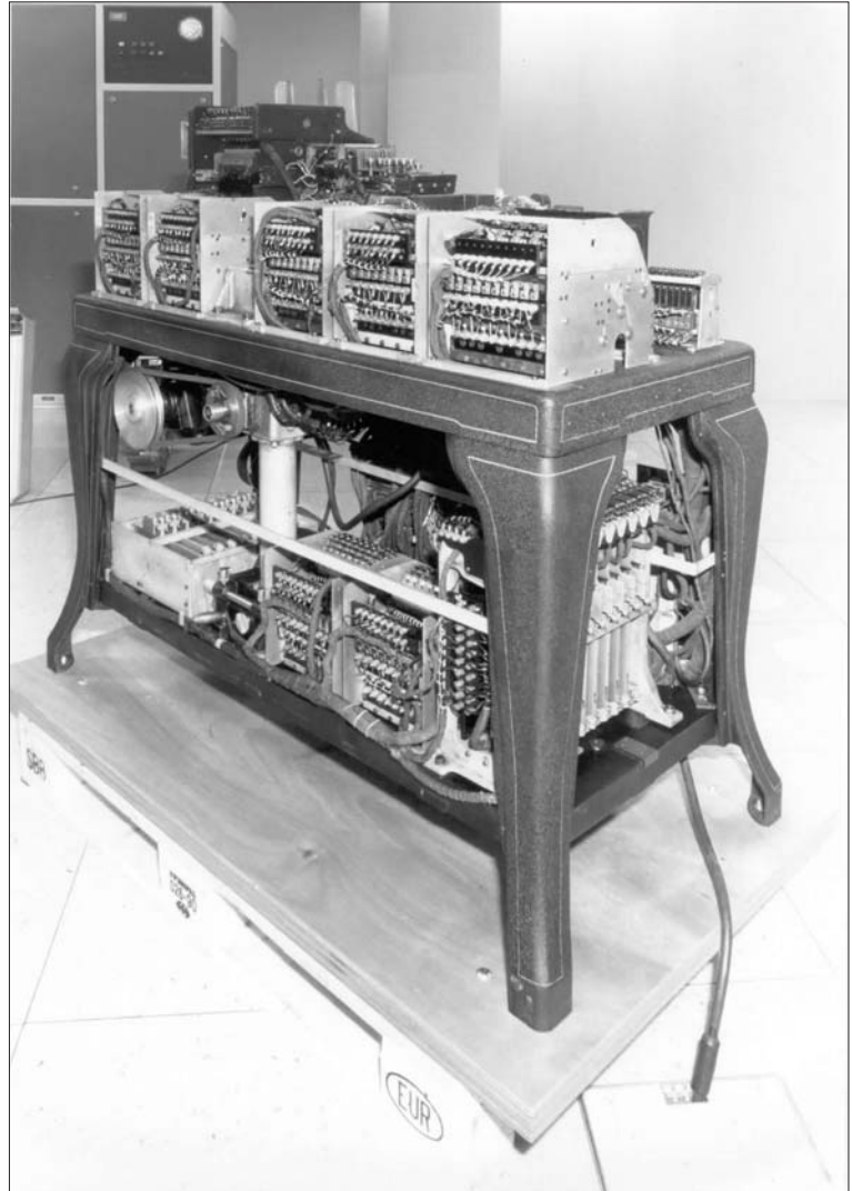
Lochkartenmaschine der PTT: IBM 601 Rechenlocher für Lochkarten, 1935
