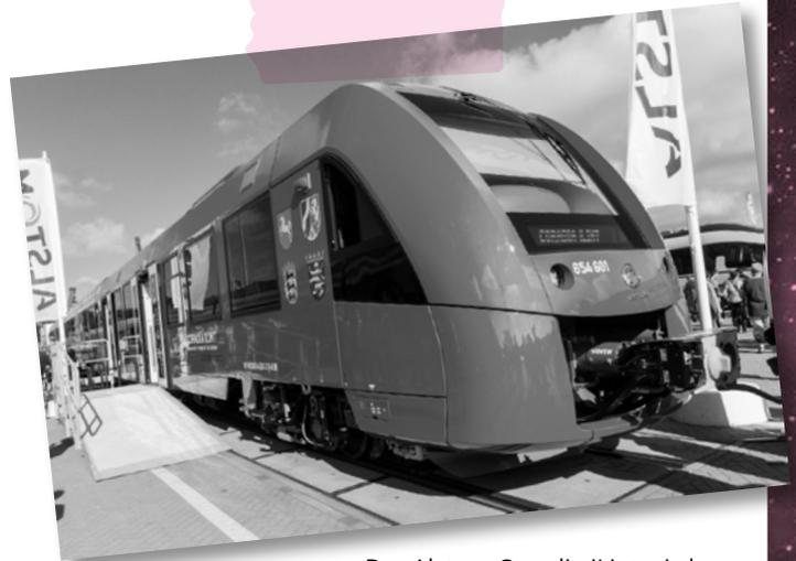
Der Alstom Coradia iLint wird durch Wasserstoff angetrieben.
