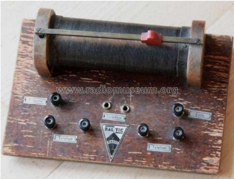
Detektorempfänger Modell Baltic Radio, Baujahr ca. 1927
