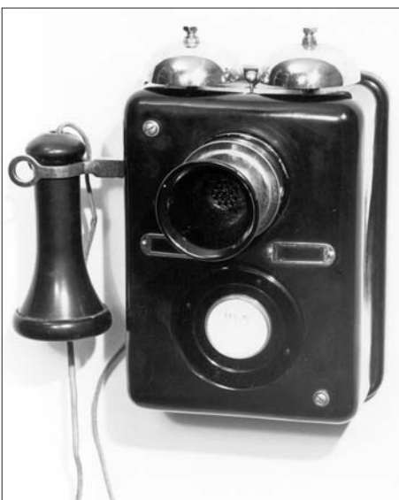
ZB-Wandapparat, konzipiert für den automatischen Betrieb
