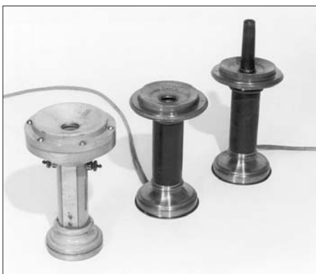
Handtelefone von Siemens & Halske (1877/78). Auf einem der Modelle ist eine Rufpfeife aufgesetzt
