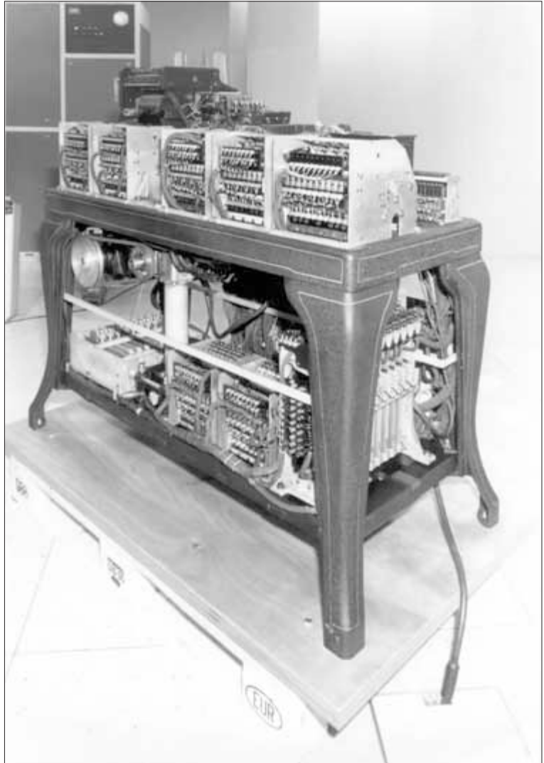
Lochkartenmaschine der PTT: IBM 601 Rechenlocher für Lochkarten, 1935
